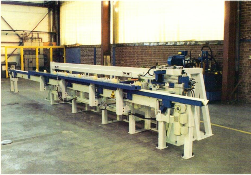
Pilgermaschineneinlauf Run-out track of a Pilger machine
